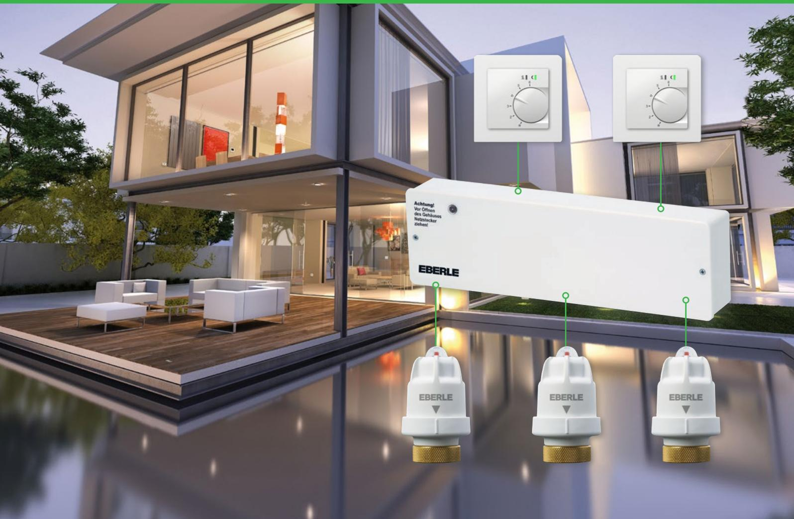
Unsere 8-fach Klemmleiste **EV 230 H oder H/K 8 Kanal** für Heizen und/oder Heizen-/Kühlen spricht für sich: Kombiniert mit dem Unterputz-Thermostat-Einsatz **UTE 2500** bietet sie ein perfekt abgestimmtes System. Durch einen entsprechenden Eingang an der Klemmleiste für das Heizen-/Kühlensignal der Wärmepumpe kann in Kombination mit UTE 2500 Reglern die Umschaltung zwischen Heizen und Kühlen automatisiert werden.
