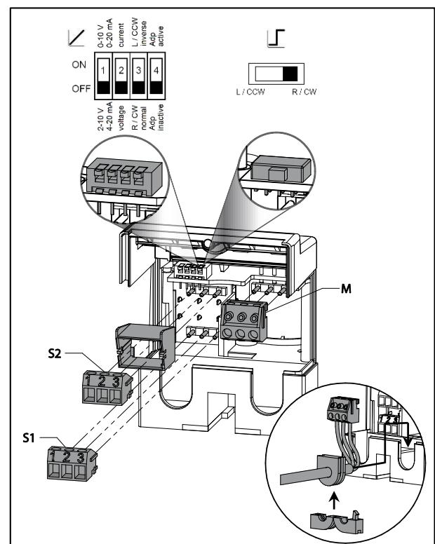
Anschluss/ connection scheme/ schema de connexion/ schema di collegamento/ esquema de connexões / schemat podłączenia/ Ligação elétrica:
