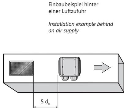
Hydraulischer Durchmesser ( $d_h$ )
