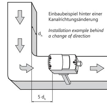
Hydraulischer Durchmesser / Hydraulic diameter ( $d_h$ )
