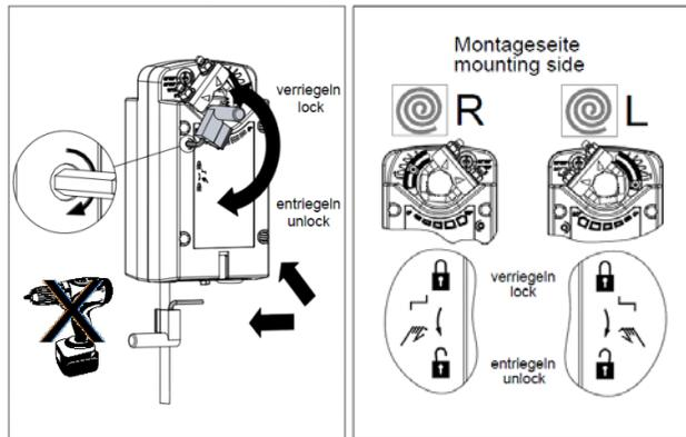
Montage/ mounting/montage/montaggio/ montaje / montaż:
