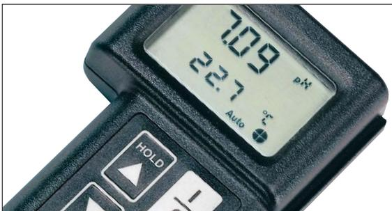
Das testo 230 vereint ein komplettes pH-Messgerät und ein vollwertiges Temperatur-Messgerät in einem kompakten, wasserdichten Gehäuse. Die Redoxspannung kann über die Redox-Elektrode Typ 06 ermittelt werden. Das Gerät besitzt eine automatische Temperaturkompensation und ist im pH-Bereich sowohl mit Standard- wie auch mit DIN-Puffern zu kalibrieren.
