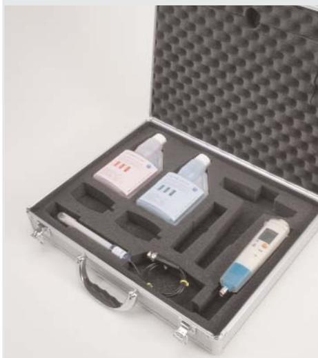
Einhand pH/°C-Messgerät, pH3-Sondenkopf mit BNC-Schnittstelle, pH-Sonde Typ 01, Aufbewahrungskappe mit Gel, Kalibrierdosierflaschen 250 ml pH 4+7, TopSafe, Gürtel-/Wandhalterung und Alukoffer
