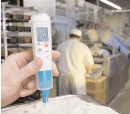
Automatische Endwerterkennung und übersichtliches 2-zeiliges Display.
