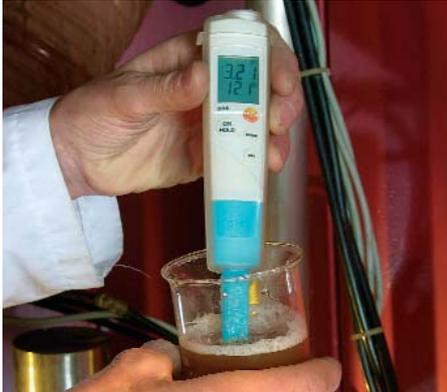
Das testo 206-pH1 ist ideal zur Messung in Flüssigkeiten
