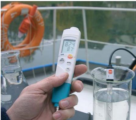
Autom. Temperaturkompensation bei externen Sonden mit Temperatursensor
