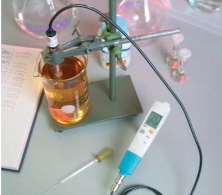
Das testo 206-pH3 ermöglicht den Anschluss externer pH-Sonden
